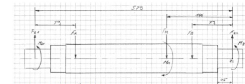
Abbildung 1: Antriebswelle Belastung in z-Richtung
