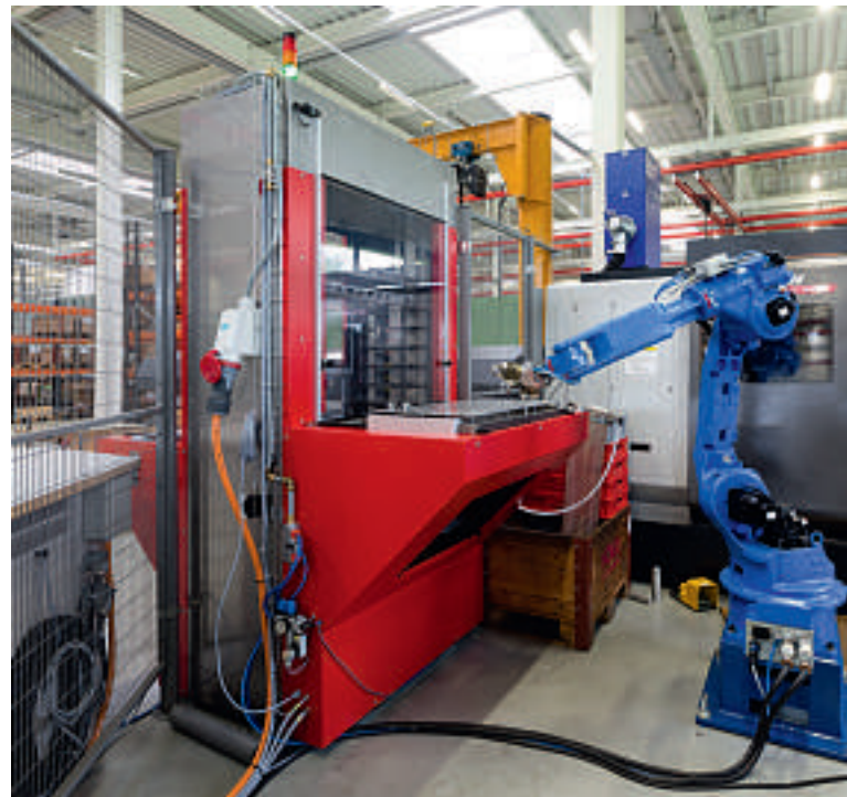
Flexibles Palettieren für die mannlose Fertigung: Die Paletten werden manuell beladen, und der Roboter kann sie chaotisch abarbeiten. (Bilder: Högg, TR)
