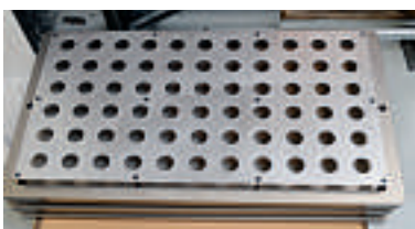
Günstig: Blechschablonen dienen als Aufnahme für die Werkstücke auf den Paletten.
