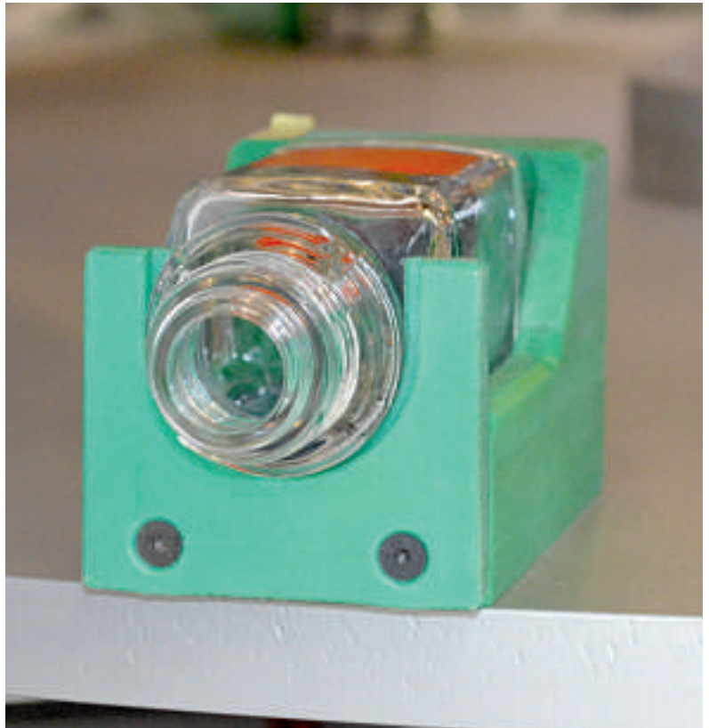
Prozesssicherer Ablauf: Die Test-Kits müssen gereinigt, tamponiert, auf Gewindegängigkeit geprüft und laserbeschriftet werden; alles innerhalb von fünf Sekunden Taktzeit. (Bilder: TR)
